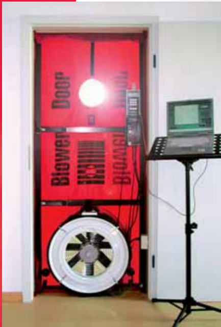
Die BlowerDoor, hier eingebaut in eine Terrassentür, sorgt für gute Bauqualität.
